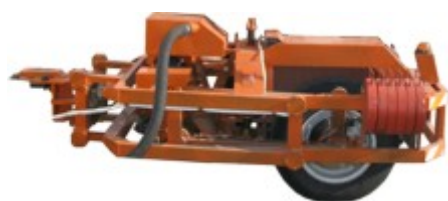
Рис.1. Прибор контроля ровности и сцепления
