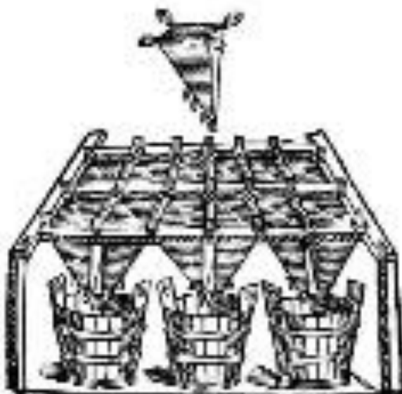
Рис. 1. Одно из первых приспособлений, функционирующих по принципу мешочной / волоконной фильтрации
