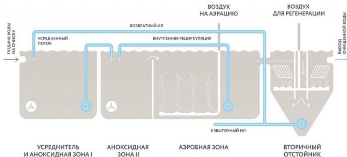
Рис. 2. Технологическая схема очистки сточных вод по технологии LBR (сформирован на основании источника [18])
