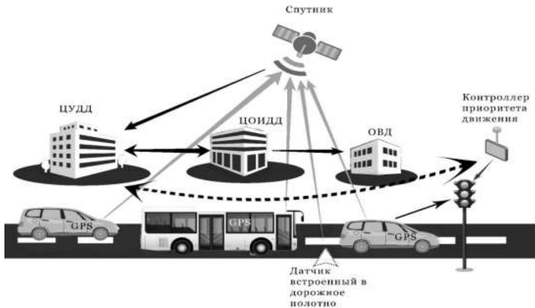
Рисунок 2.2 – Информационная система управления дорожным движением [составлено автором на основе [62-65]]
